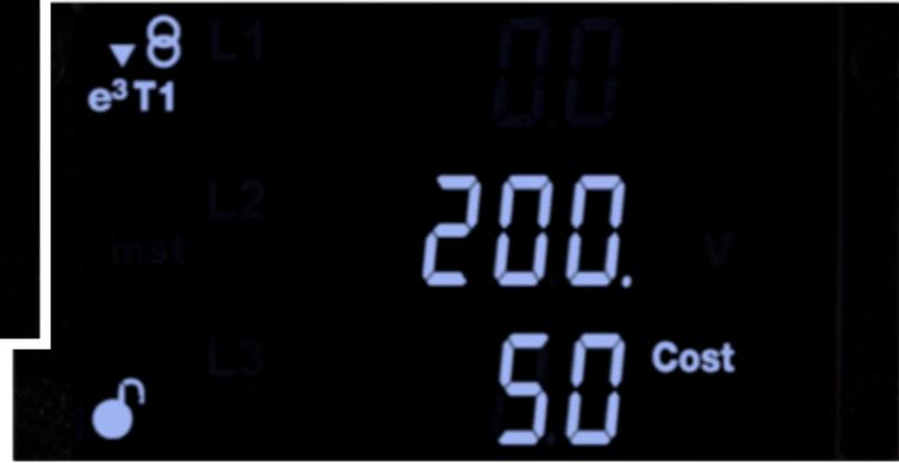
› Entre les différentes possibilités de mesurage, il faut en distinguer certaines comme la mesure du coût monétaire de l'énergie, les heures de fonctionnement, les émissions de CO<sub>2</sub> et la mesure des harmoniques jusqu'à 31°.
