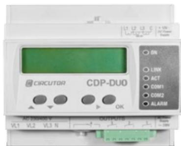
**CDP-DUO** est le modèle le plus avancé des contrôleurs dynamiques de puissance destiné à contrôler les installations hybrides (alimentées par deux sources alternatives d'énergie). L'équipement mesure à tout moment la consommation de l'utilisateur et, grâce à sa double configuration, règle les inverseurs pour adapter la génération solaire au type de réseau et/ou générateur qui serait présent.
