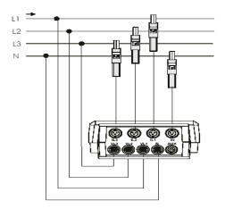
**3.**- Una vez conectado el analizador, vaya a la pantalla de datos en tiempo real y verifique que los datos mostrados son coherentes o dentro del rango esperado. En caso contrario, repase el conexionado de los cables y pinzas de medida a la red.
